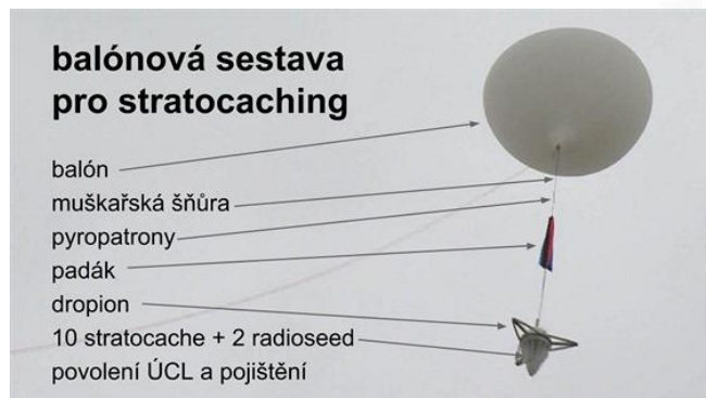
Obr. 2: Balónová sestava pro stratocaching [3]
